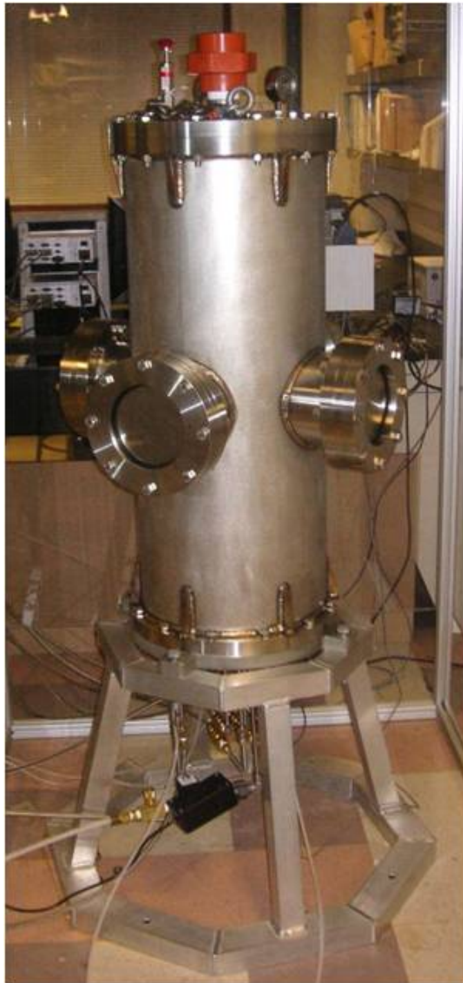
Abbildung 12: Geschlossene Druckkammer mit Gasleitungen durch die Bodenplatte und auf der Deckelplatte montiertem Überdruckventil und Berstscheibe
