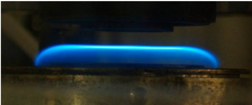
Abbildung 9: Eine nicht-vorgemischte Methan-Luftflamme mit einem Kraftstoffmassenanteil von 0.35 bei einfachem atmosphärischem Druck.
