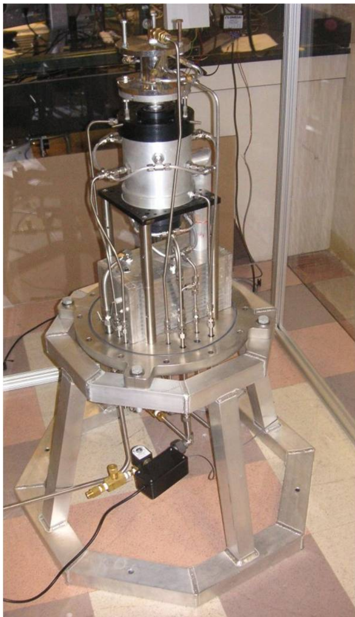
Abbildung 13: Gegenstrombrenner mit installierten Gasleitungen, montiert auf der Bodenplatte.
