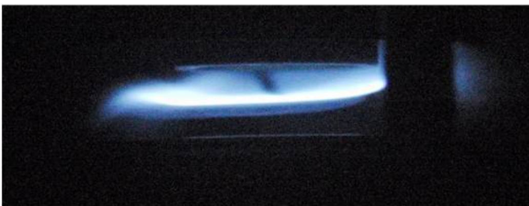
Abbildung 10: Eine nicht-vorgemischte Methan-Luftflamme mit einem Kraftstoffmassenanteil von 0.25 bei drei 3bar Druck.
