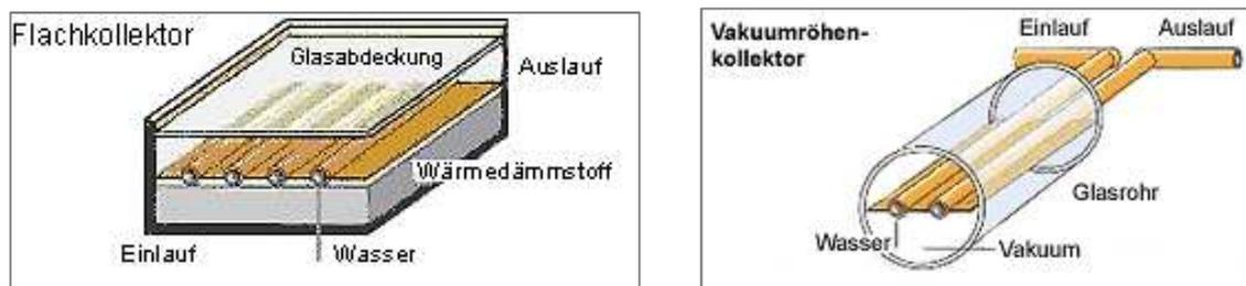
Abbildung 30: Flach- und Vakuurröhrenkollektor.
