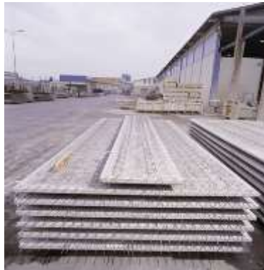
Figure 22: Elementdecke, URL: http://www.oberndorfer.at/produkte/wandsysteme/beto-therm-wand/
